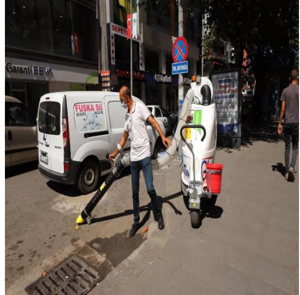
Resim 3 : Elektrikli Tip Vakumlu Temizlik Aracı
