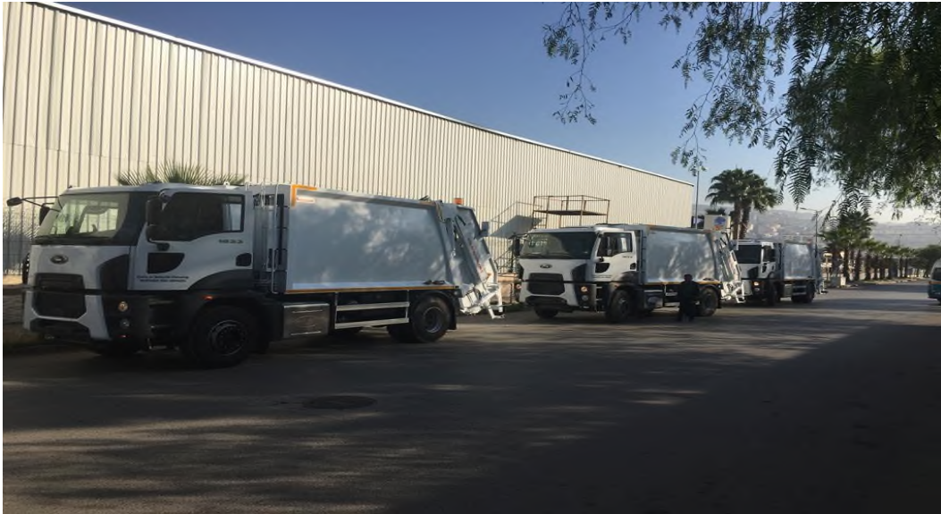
Resim 3 : 6+1 m 3 hidrolik sıkıştırılmalı çöp kamyonu
