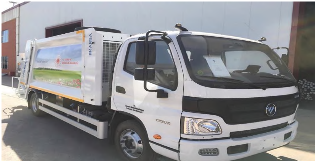
Resim 3 : 6+1 m 3 hidrolik sıkıştırılmalı çöp kamyonu
