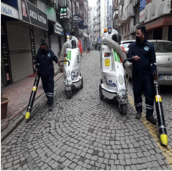
Resim 3 : Elektrikli Tip Vakumlu Temizlik Aracı
