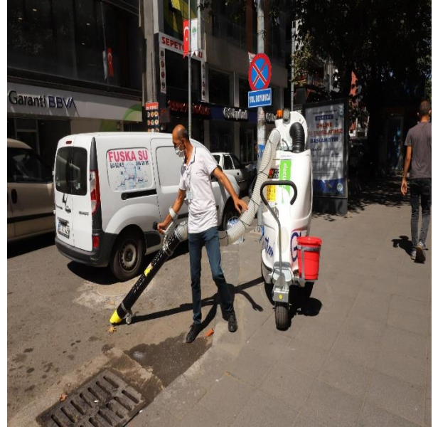
Resim 3 : Elektrikli Tip Vakumlu Temizlik Aracı
